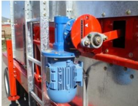
Motor del Excéntrico de Descarga
